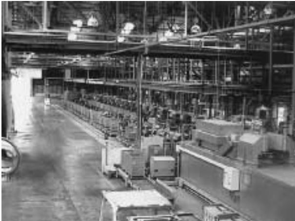
写真2 生産工程(グリッド・キャスト工程) Photo 2 Production line of grid casting plant
