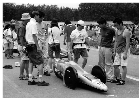
写真-2 2001年各大会で活躍し、フォイル・イン・モーターの普及に貢献した(株)ミツバのUSO800(ワールドソーラーバイクレース・カテゴリ-S仕様)
