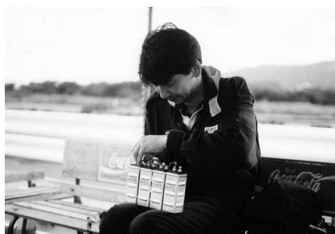
写真-1 走行前にキャパシタの配線確認をする木村英樹氏(ソーラーバイク用;日本ケミコン(株)製角型電気二重層キャパシタ, 15V-65F 4直)
