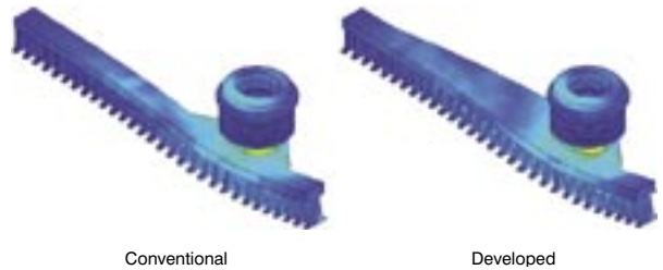
図7 ストラップ応力分布比較 Fig.7 Comparison of the stress on battery straps
