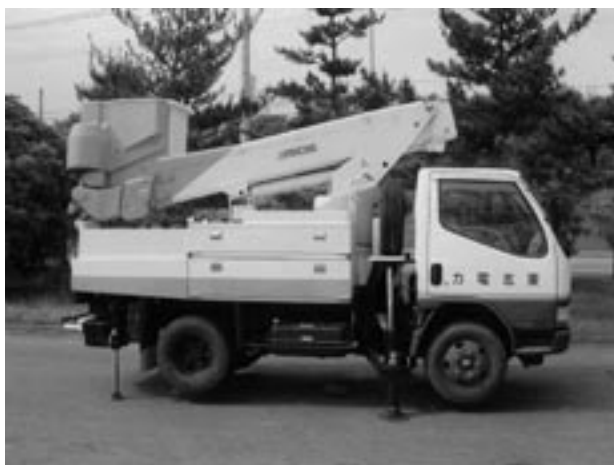
図 1 ニッケル・水素電源システム搭載型高所作業車 U488-02
