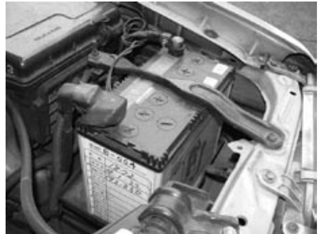
図 13 開発仕様エフガードのタクシー実車搭載状態 Fig.13 Installed FGUARD for development on taxi car
