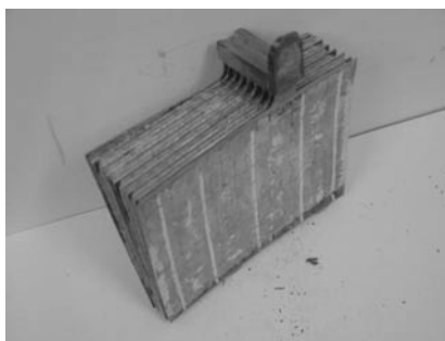
図2 ストラップと極板格子の結合状況 Fig.2 Cell's plate group with a strap and nine (9) plates
