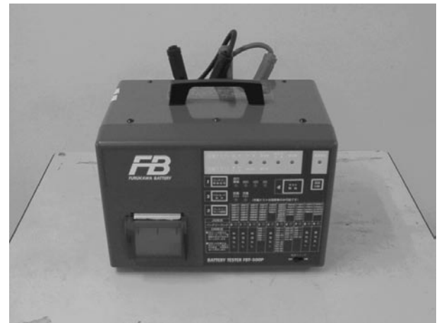
図3 FBT-500Pの外観（質量約4.7kg、サイズW200×L300×H200mm） Fig.3 External view of FBT-500P
